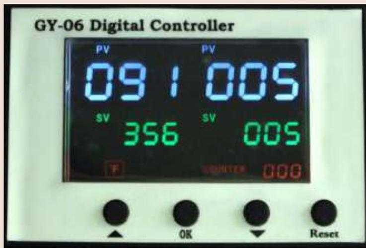
Pulse el botón ok para pasar al modo de funcionamiento. El contador es "ciclo de transferencia", de 0~999. Pulse "reset" durante 5 segundos para que el contador sea "0"
