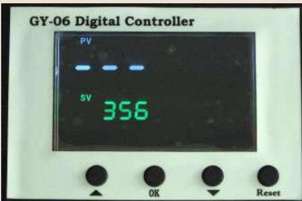
Pulse el botón Ok, la luz de la temperatura se enciende. Seleccione con las flechas la temperatura según los diferentes materiales de transferencia (180°C~200°C)
