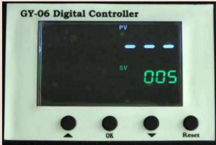
Pulse el botón Ok después del ajuste de la temperatura y la luz de la hora se enciende. Seleccione con las flechas el tiempo de acuerdo a los diferentes materiales de transferencia.
