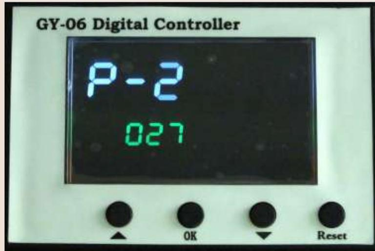
Si la diferencia entre SV y PV es grande, pulse el botón OK durante 5 segundos y vuelva a pulsar el botón OK para ajustar la temperatura. Si SV y PV tienen una diferencia de 20 grados, pulse las flechas para ajustar a 20
