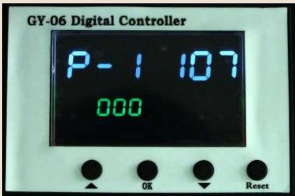
Cuando la temperatura mostrada en la pantalla no es la misma que la temperatura real de la placa térmica, pulse el botón durante 5 segundos para restablecer el modo.
