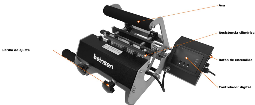
Fig. 1 · Componentes principales del equipo Beinsen Barahona.
