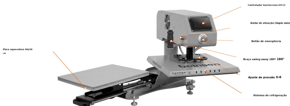
Fig. 1 · Componentes principais do equipamento Beinsen Felina.
