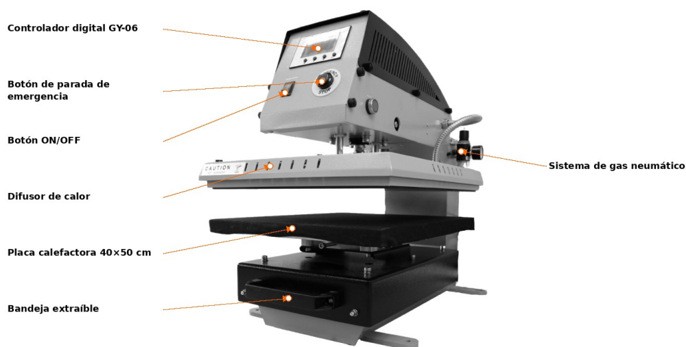
Fig. 1 · Componentes principales del equipo Beinsen Luanda.
