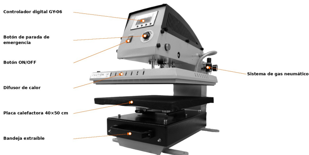
Fig. 1 · Componenti principali della macchina Beinsen Luanda.
